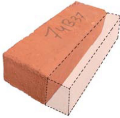
Fig. De ontwikkelde renovatiesteen in zogenaamde 'Almere-formaat' welke 3 centimeter smaller is zodat de geveldiktes gelijk blijven (GoedeStede).
