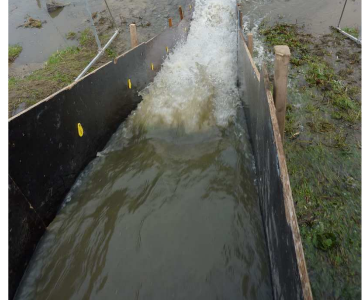
Geen schade bij overloop met debieten van 160l/m/s
