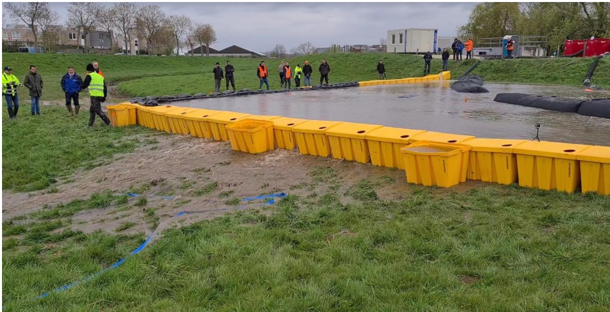
Figuur 1: Falen door onderloopsheid van de BoxBarrier in de Groene Rivier.
