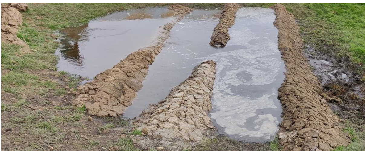
Figuur 16: Middelste dijk bezwijkt gedeeltelijk en water stroomt naar rechter dijk (Thönissen, 2023)
