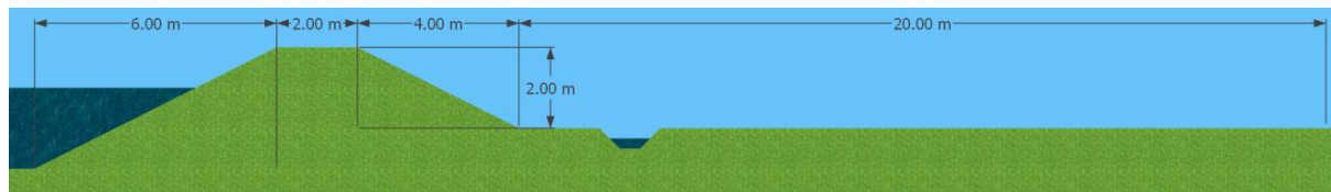
Figuur 3: Dwarsdoorsnede regionale waterkering (Thönissen, 2023)
