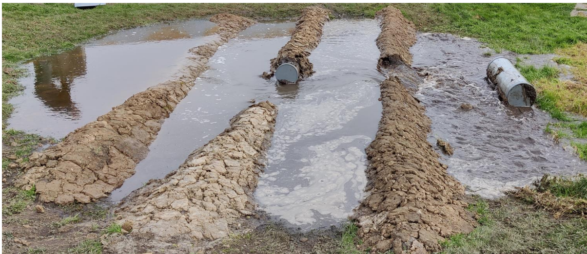
Figuur 17: Tanks in middelste en rechter dijk drijven op (Thönissen, 2023)
