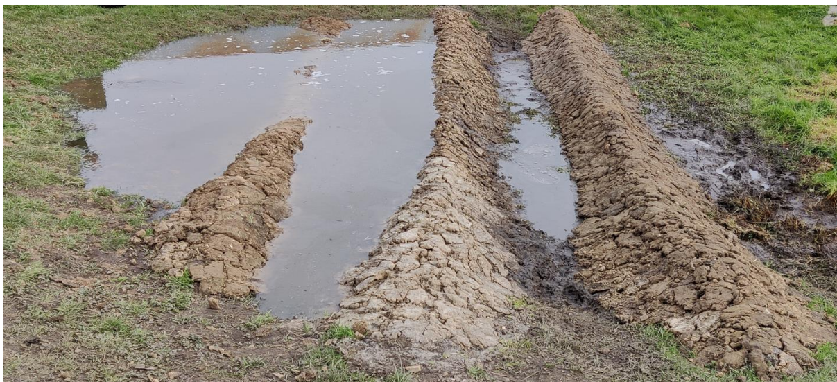
Figuur 15: Water bereikt middelste dijk (Thönissen, 2023)
