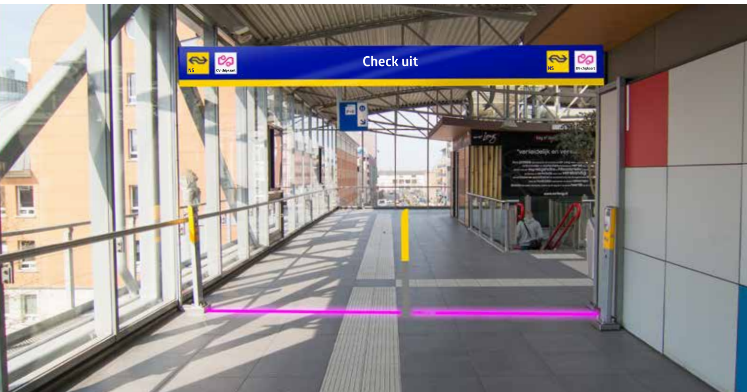
Figuur 27: Fotomontage van een toegang aan de achterzijde van station Den Bosch met het initiële voorstel; een extra cico is toegevoegd om de doorgangsbreedte te beperken.
