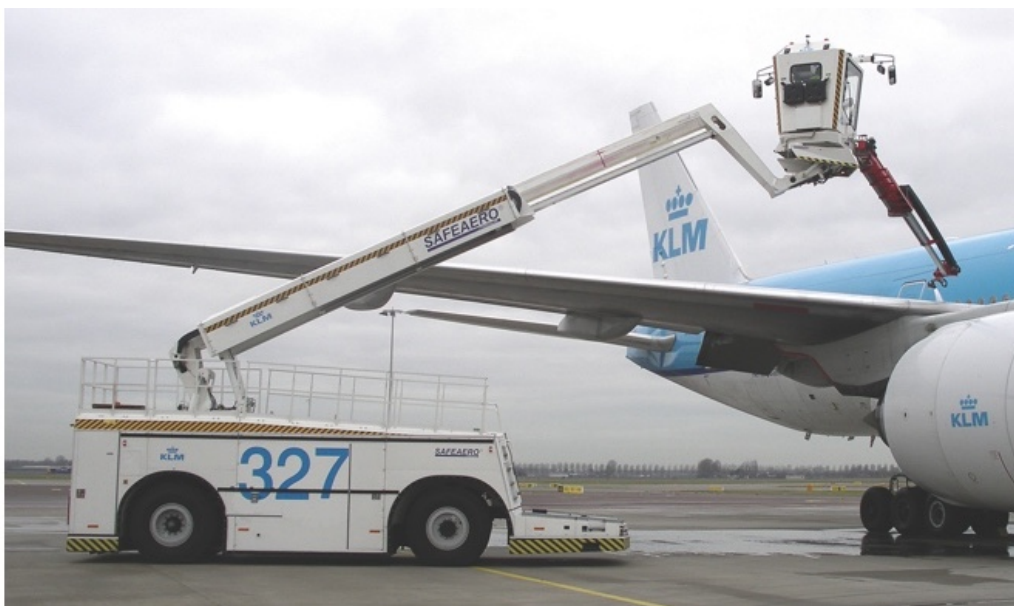
Abbildung 5.8: Enteisungsfahrzeug vom Typ Safeaero 220 der Firma Textron an einem Großraumflugzeug vom Typ Boeing 777 (Textron, 2018)
