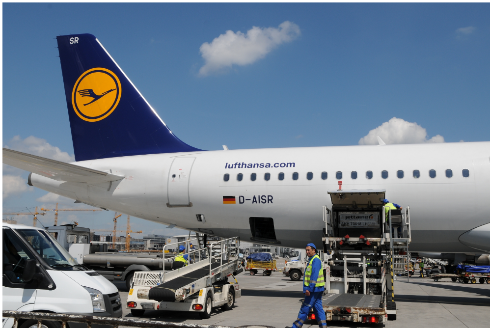
Abbildung 5.4: Beladung eines Airbus A321-200 mit Containern und Bulk Cargo (Ingrid Friedl, Lufthansa, 2010)
