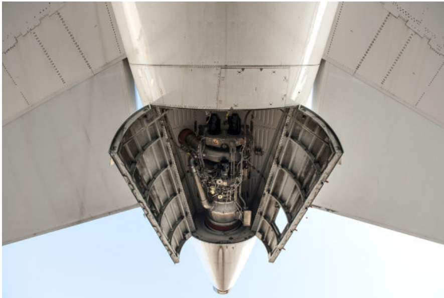
Abbildung 5.6: Hilfstriebwerk im Heck eines Airbus A380-800 (Liebich, Lufthansa Technik, 2014)
