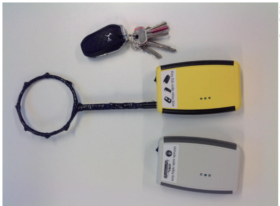
Set waarmee een auto met keyless entry kan worden geopend.
