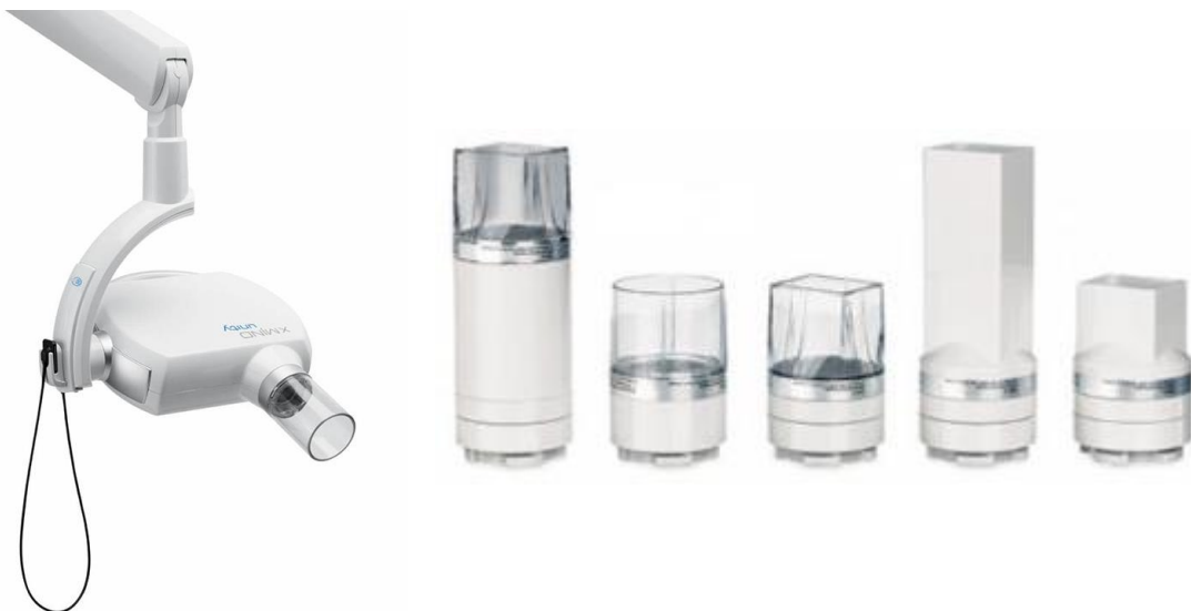
Figuur 2: links: een röntgentoestel voor tandheelkundige toepassingen, rechts: verschillende tubusvormen, met lange en korte tubus en ronde en vierkante collimatoren. Een tubus zorgt voor het begrenzen van de bundelomvang en zorgt voor een vaste focus-huidafstand.
