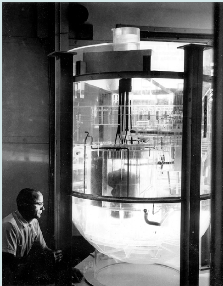
Een schaalmodel (1:6) van het Oak Ridge National Laboratory's Molten Salt Reactor Experiment. De MSRE bereikte kritische kritische (criticality) op 1 juni 1965 en bereikte zijn volledige vermogen van 7.500 kilowatt in mei 1966. De foto is gemaakt in 1968. (Foto: US Department of Energy)
