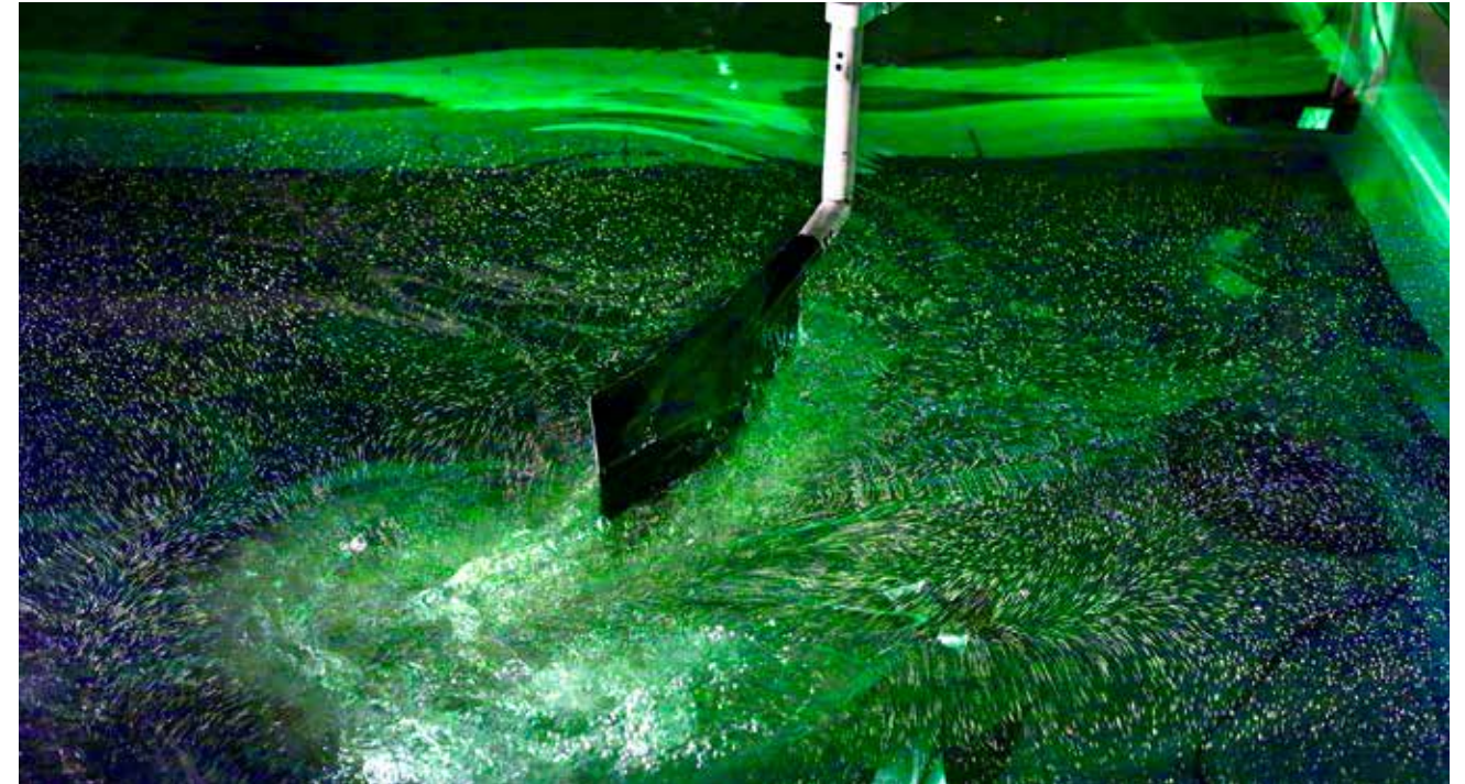
Een roeiblad (schaal 1:2) beweegt door een horizontaal vlak met laserlicht terwijl een camera onder de opstelling door 10 cm dik glas de stroming vastlegt. Promovendus Ernst-Jan Griffit onderzoekt versnellende en vertragende stroming rond het blad om te zien hoe roeiers sneller kunnen gaan.
