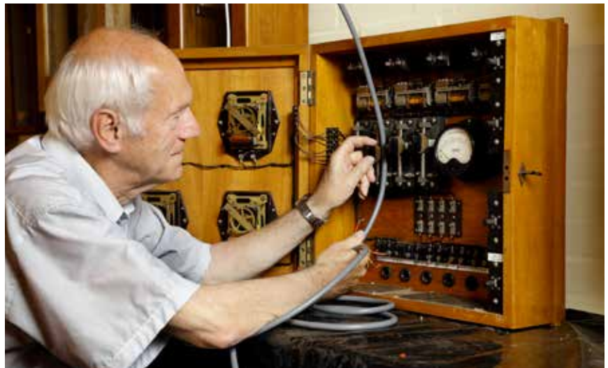
Rob Timmermans: "Moederklokken waren zeer nauwkeurig en vaak diep onder de grond in kelders weggestopt, vrij van trillingen, druk- en temperatuurwisselingen."
