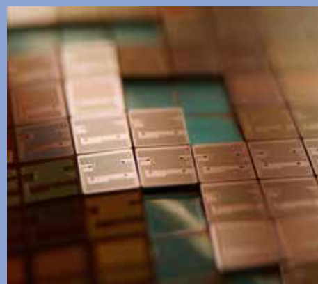
De microfluidische chips zijn maar 3x3 millimeter en na uitzagen klaar om getest te worden. Foto: Ronald Stoute
