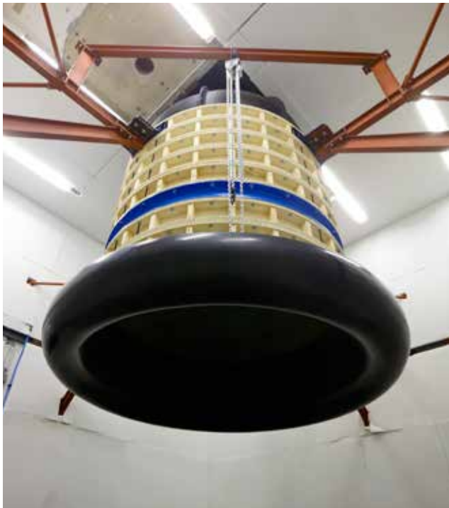
De lucht wordt in de inlaat gezogen en door de trechtervorm versneld. Twee verdiepingen hoger komt de buis uit in de meetkamer (zie coverfoto) van de windtunnel.
