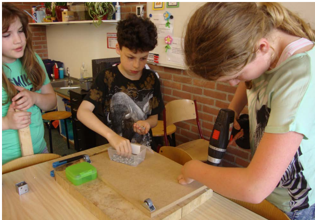
Figuur 44. Zwenkwielletjes aan onderstel bevestigen
