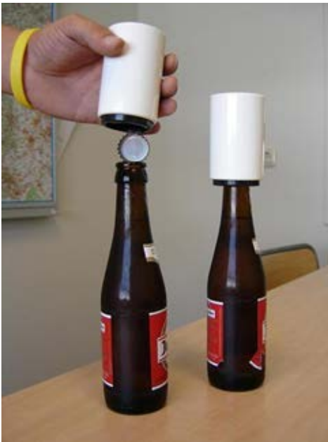
Figuur 6. Flesopener. Eenvoudig de "click off" over de flessenhals plaatsen en licht drukken. De kroonkurk komt direct los en blijft aan de ingebouwde magneet hangen. (Bron: www.reumahulpmiddelen.nl )
