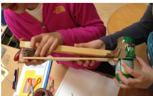
Figuur 63. Met elastiekjes kan de grijper open
